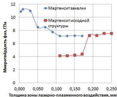
Рисунок 7. Влияние лазерно-плазменной обработки на микротвёрдость структурных составляющих по глубине поперечного сечения в стали с исходной структурой – мартенсит (составлен автором)
